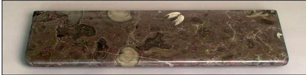
Parapet z „Bolechowic Ciemnych” - naroża zaokrąglone, krawędzie wykończone ćwierćwałkiem
